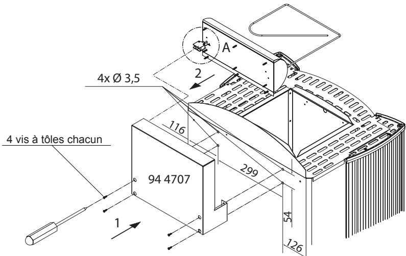
toutes les vis à tôle : pour la suspension de la protection du poêle
