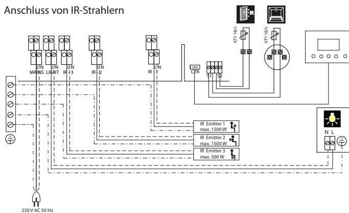
Anschluss von IR-Strahlern und Heizfolien
