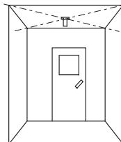
Deckenbefestigung des Fühlers
