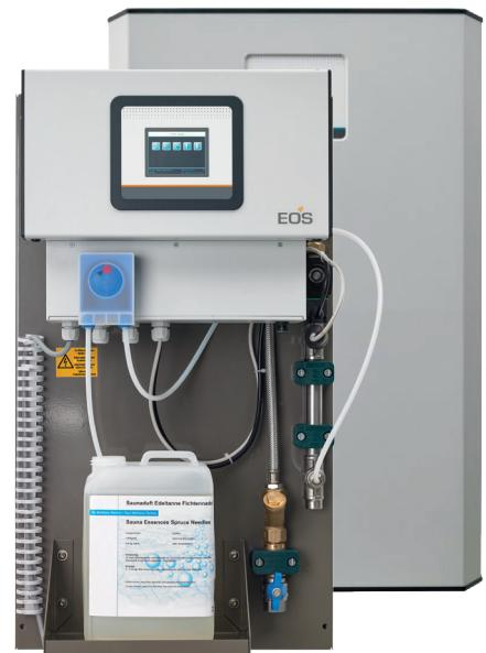
Die Anlage muss auf einem höheren Niveau als der Ofen / die Brause installiert werden. Ist dies nicht möglich oder wird die Leitung steigend verlegt, so muss ein Systemtrenner nach EN1717 im Zulauf eingebaut werden!
