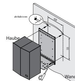
Nur Wandmontage. Die Montage ist auf dem Niveau der Dampfkabine oder unterhalb bzw. oberhalb der Kabine möglich.
