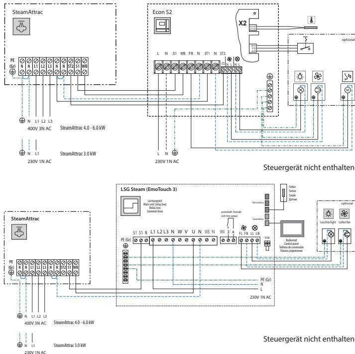
Anschlussbeispiel für das Steuergerät EOS Econ S2 und LSG Steam. Bei anderen Steuergeräten entnehmen Sie bitte die technischen Daten den jeweiligen Montageanleitungen. Steuergerät nicht im Lieferumfang enthalten.
